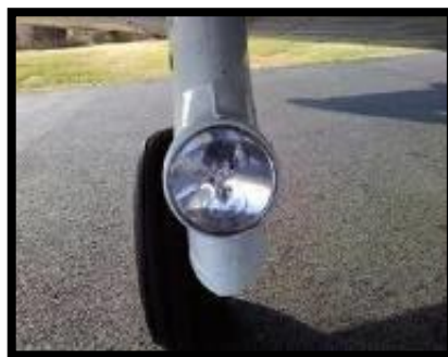
Gambar 7.8 (Landing Light saat EXTEND)
