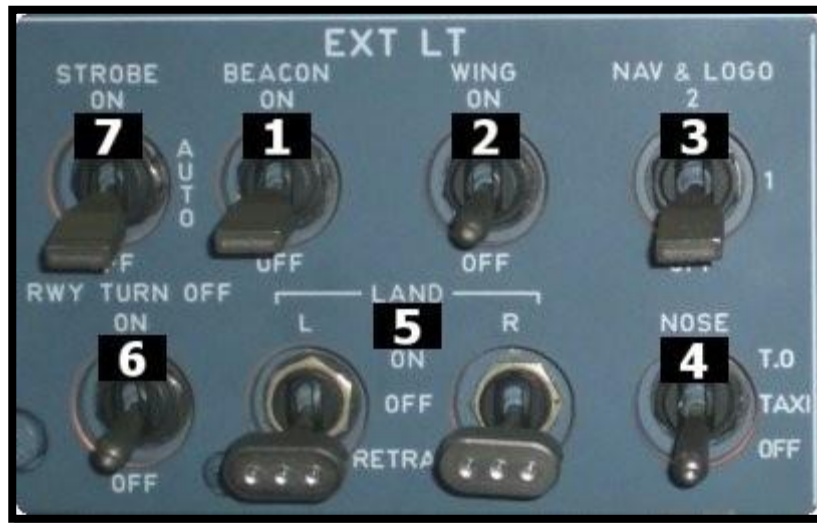
Gambar 7.7 (Selektor Kontrol Lampu Pendaratan)
