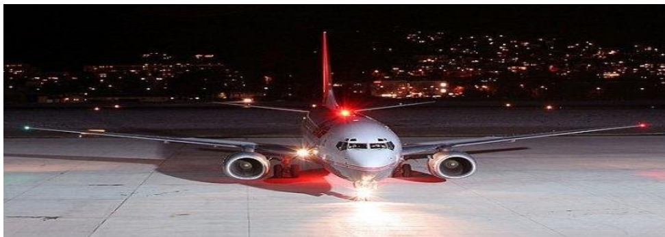
Gambar 7.11 (Anti Collision pada posisi lampu di atas)
