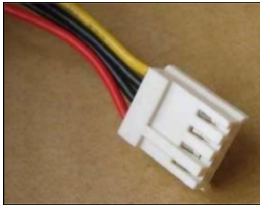
e. Konektor Power FDD 4 Pin
